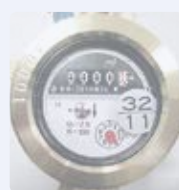
水道メーター
