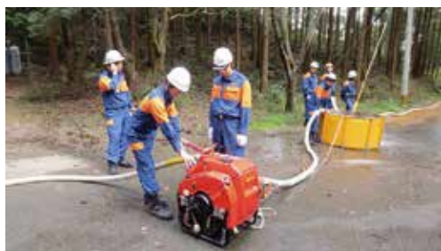
可搬 消防ポンプ
