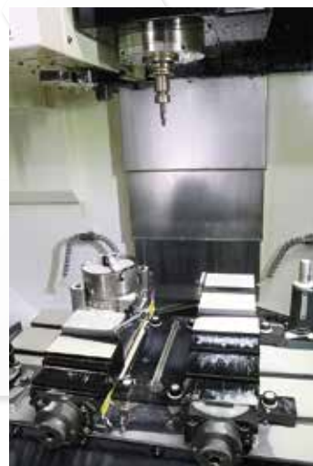
マシニングセンター コンピューターの数値制御によって精密な加工を行います。
